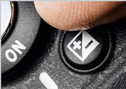
**Genauere Korrektur:** Mit dieser Taste können Sie stufenweise unter- oder überbelichten.
